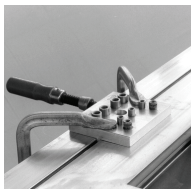
Bohren der Bandbefestigung
