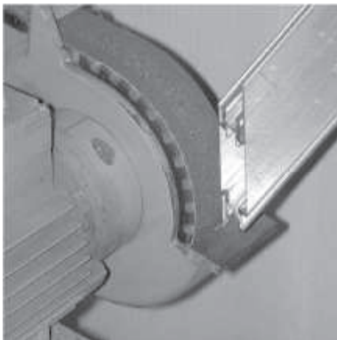
Schleifen der Schnittkante
